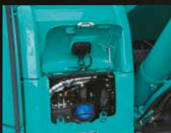
DEF-tank op grondniveau
